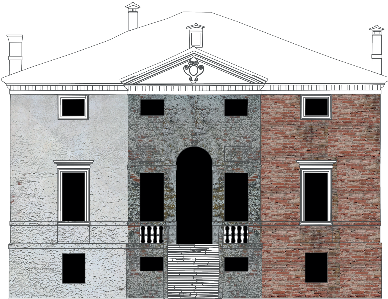
STRATIFICAZIONE DELLA MURATURA - PROSPETTO SUD SCALA 1:50
