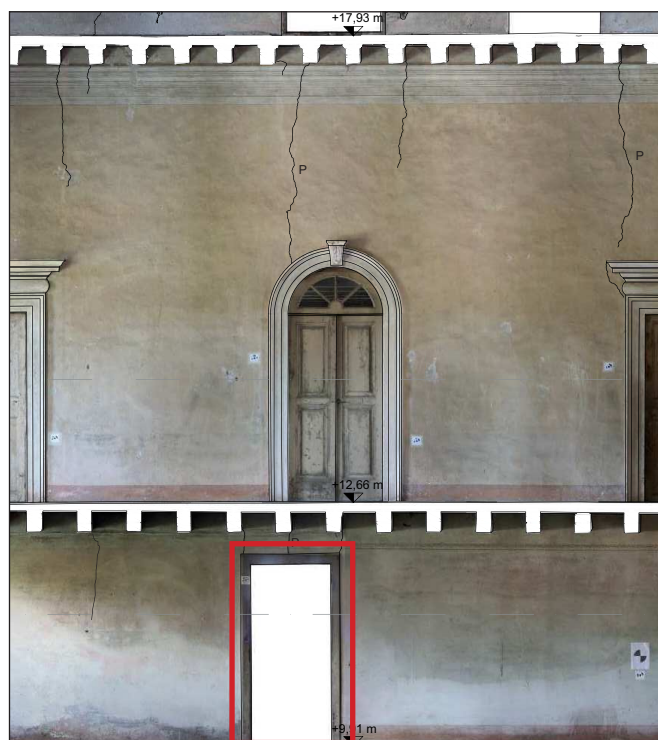
Confronto fra le porte ai piani nobile e terra nel rilievo del 1778 e nello stato di fatto
