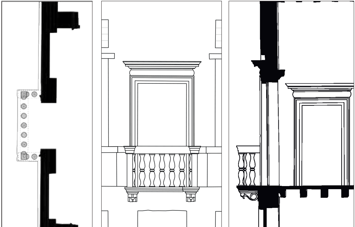
Disegno delle balaustre in pianta, prospetto e sezione
