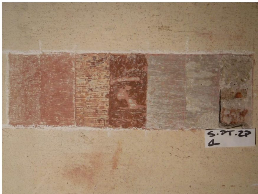
Esempio di stratigrafia – stanza 2 – parete nord
