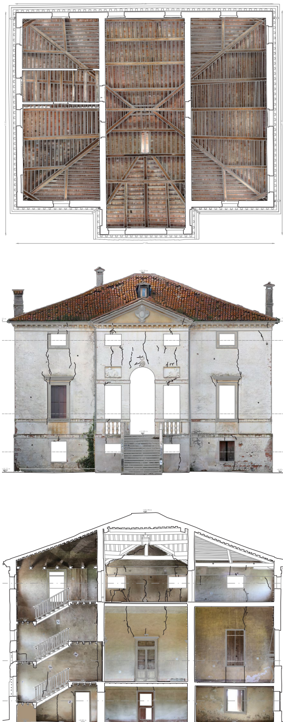
Fig. 1. Rilievo laser scanner 3D ed ortofotopiani interni ed esterni di Villa Forni Cerati, Politecnico di Milano (2018).
